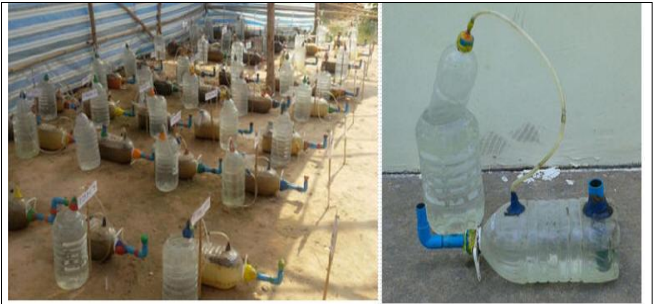
Fotos 1-2. Los biodigestores a pequeña escala hechos de botellas de agua de polipropileno reciclado.
